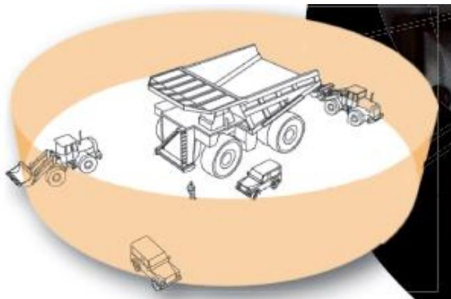
**Système de vision 360°**, zone ajustable en adéquation avec le type et l'application du véhicule.
